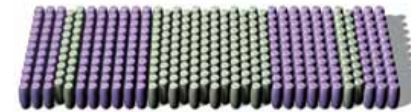
Schematische Darstellung fest: 1,8 mm parallel, 2,0 mm versetzt
